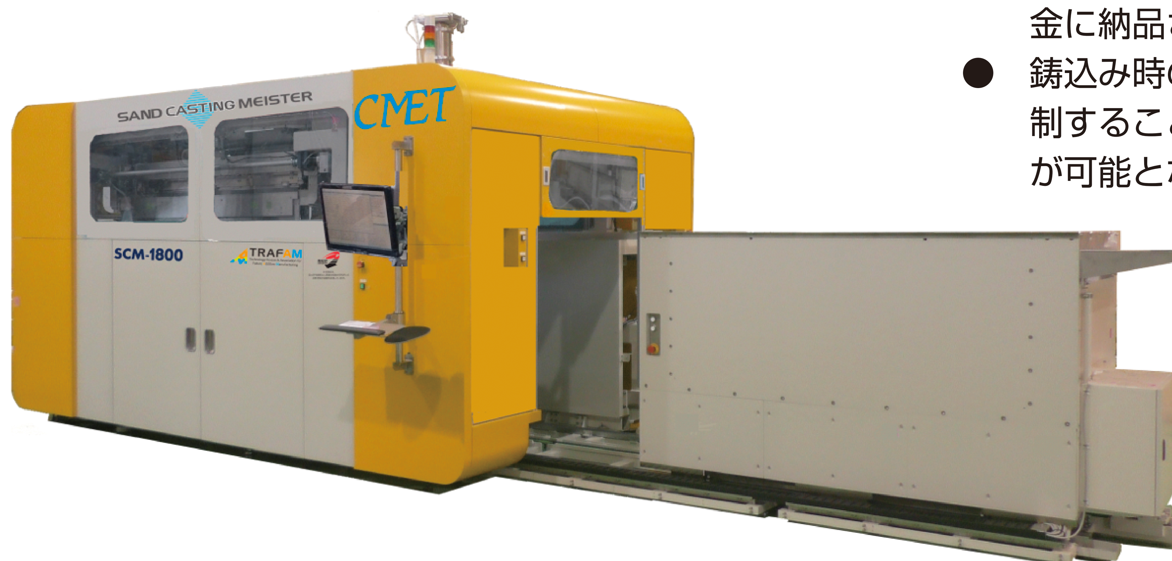
鑄造用砂型の3Dプリンター（シーメット社製）
