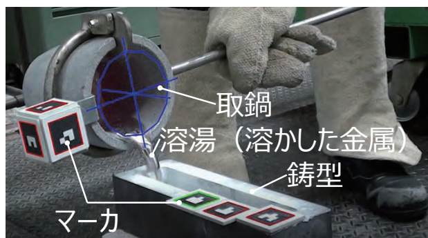
マーカによる注湯動作の計測
