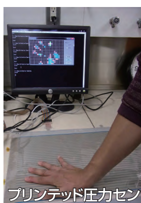
印刷法で作製した圧力センサシート
